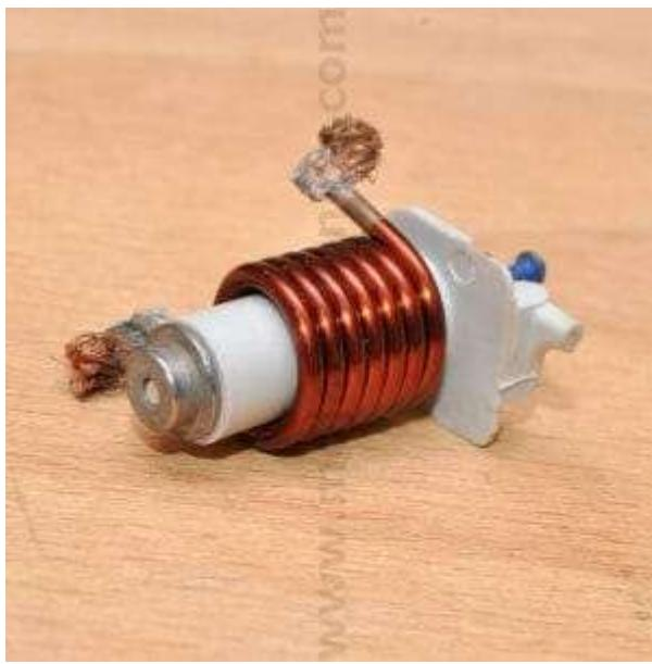
Elektromagnet isključuje struju kratkog spoja kada je ona za 3 i više puta veća od nazivne struje. U zavisnosti od brzine reakcije elektromagneta automatski osigurači se dele na brze (B) i spore (C). Brzi (B) kod struje 3 do 5 puta veće od nazivne ne sme da reaguje ispod 0,1 sekunde, a kod struje koja veća od 5 puta u odnosu na nazivnu mora da reaguje ispod 0,1 sekunde.
