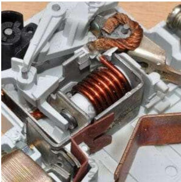
Kako bi reakcija bimetalne trake bila suviše spora u slučajevima struje kratkog spoja, osigurač je snabdeven i elektromagnetom. Sila koja pomera jezgro elektromagneta srazmerna je jačini struje kratkog spoja koja, u datom trenutku, protiče kroz namotaje elektromagneta. U takvim situacijama osigurač brzo prekida strujno kolo tako što elektromagnet uvuče jezgro, a ono pomera sistem poluga sa oprugom koji razdvaja kontakte sklopke.
